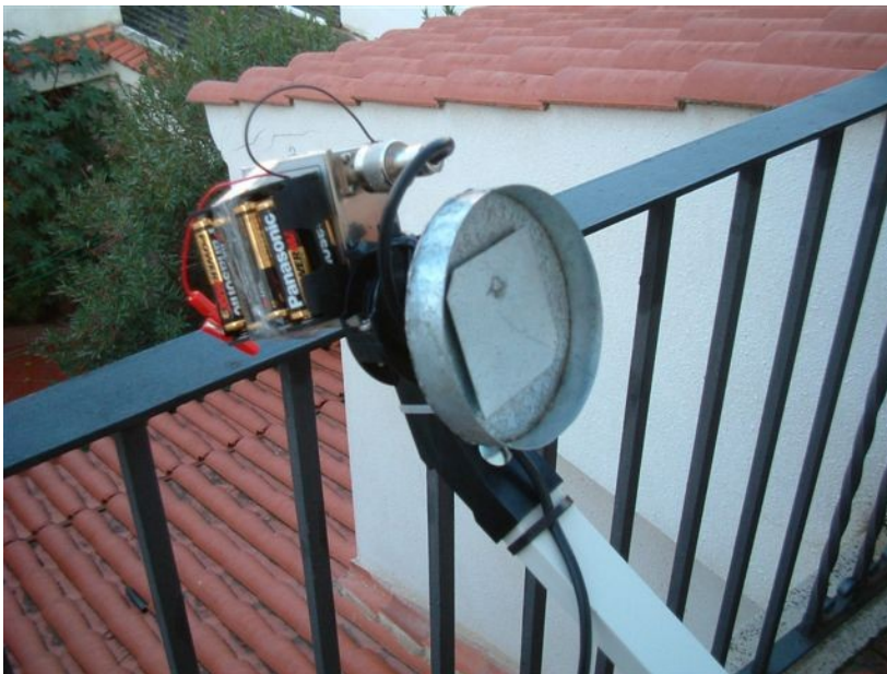
Foto 6: Patch-feed instalado con convertidor y alimentación para activación portable EB4DKA
