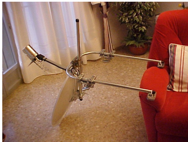
Foto 9: Detalle de la estructura soporte de la parabólica con los contrapesos
