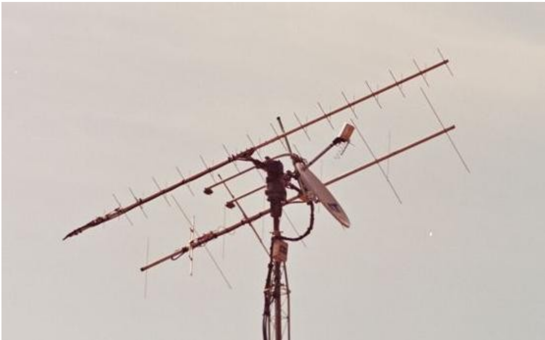
Vista lateral de sistema radiante de una estación de satélites típica
