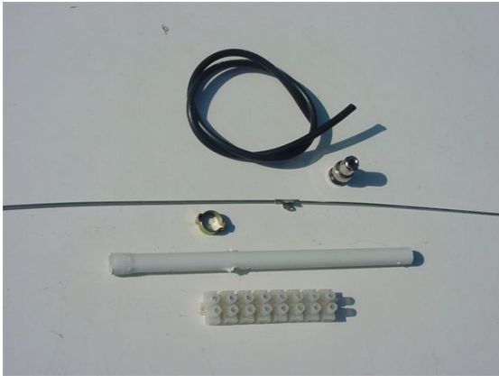
Foto 1: Materiales necesarios para construir la Antena 'CJU'
