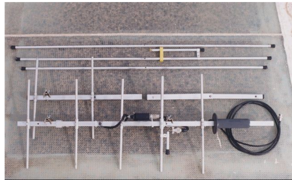
Foto 5: Antena desmontada para transporte
