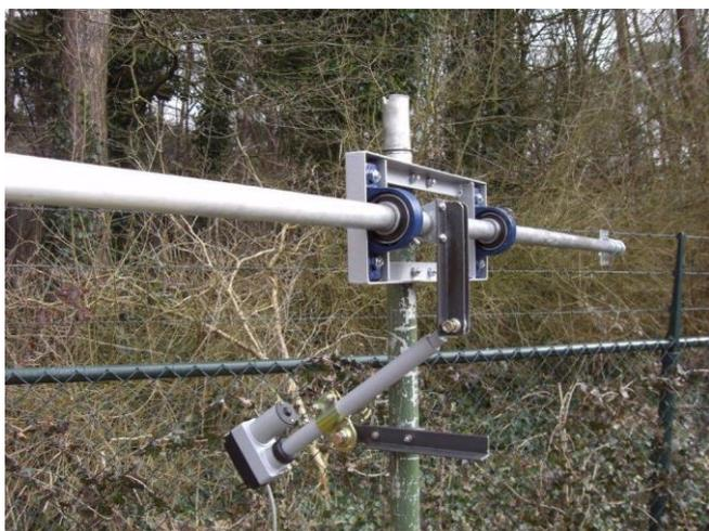
FOTO 2.- ELEVACIÓN MEDIANTE ACTUADOR DE PARABÓLICA DE PA5MS
