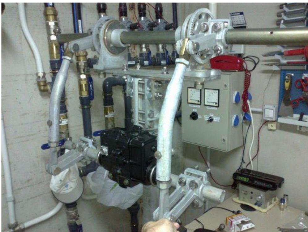
FOTO 4.- SISTEMA DE ELAVACIÓN DIFERIDO POR BIELAS DE EA4CYQ
